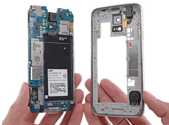
ภาพที่ 2 แสดงตัวตรวจจับภายในโทรศัพท์มือถือ
